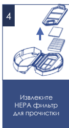
При необходимости промойте HEPA фильтр тонкой струей воды
